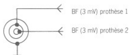
Fig. 3: Brochage de la borne de sortie BF (position du commutateur «3 mV»)
